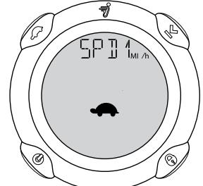
Appuyez sur le bouton de sécurité (🔒) pour afficher la vitesse disponible suivante. Les options de vitesse du mode Débutant vont de 6,4 km/h (4,0 mi/h) à 13 km/h (8,0 mi/h) en incrément de 0,8 km/h (0,5 mi/h).
