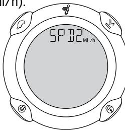
Une fois que votre vitesse préférée est affichée, appuyez une nouvelle fois sur le bouton d'affichage d'informations (✓) pour enregistrer la vitesse du mode de conduite Débutant. Le dispositif de commande InfoKey doit afficher l'information apparaissant à droite.
